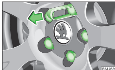
Obr. 137 Stažení krytky šroubu kola
