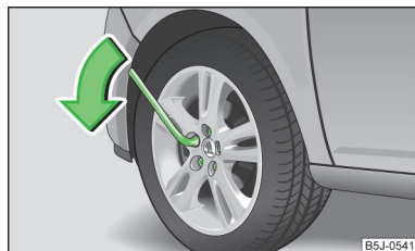
Obr. 141 Výměna kola: povelení šroubů
