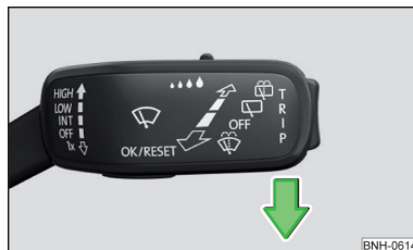
Obr. 328 Nastavení servisní polohy stěračů
