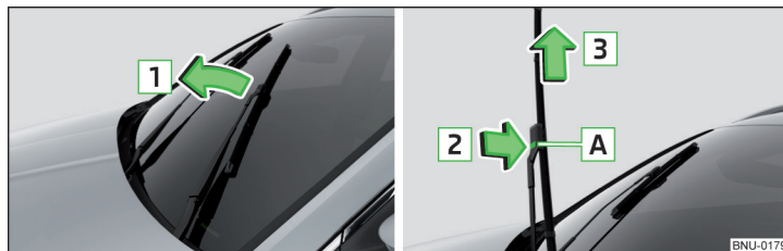
Obr. 329 Výměna stírací lišty čelního skla
