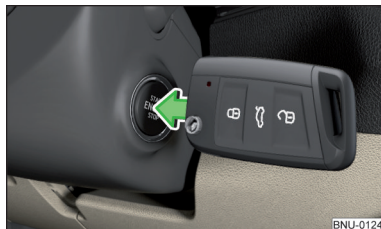
Obr. 236 Startování motoru - přidržení klíče u tlačítka
