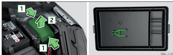
Obr. 335 Kryt pojistek: vyjmutí krytu / plastová svorka na pojistky
