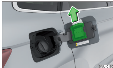
Obr. 291 Umístění a vyjmutí škrabky na sníh a led
