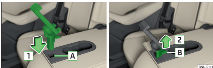
Obr. 125 Vložení držáku / Vyjmutí držáku
