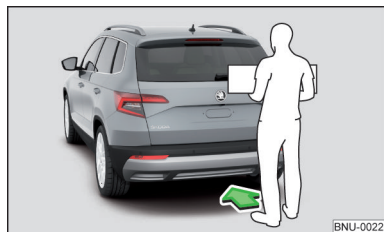
Obr. 51 Otevření víka zavazadlového prostoru
