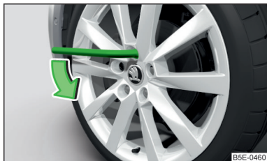
Obr. 313 Povolení šroubů kola
