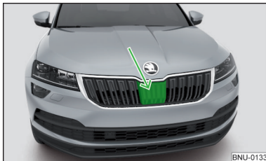
Obr. 248 Umístění radarového snímače
