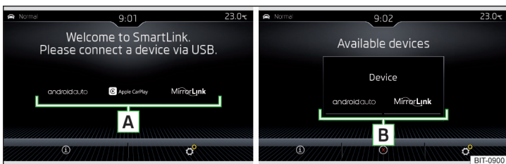
Obr. 198 Podporované komunikační systémy / Příklad dostupných komunikačních systémů připojeného externího zařízení
