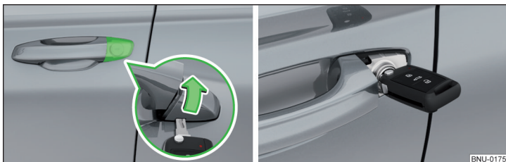
Obr. 324 Klikla dveří řidiče: odklopení krytu zámku / vložka zámku s klíčem
