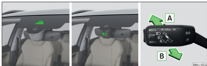
Obr. 60 Varianty umístění snímače / Zapnutí/vypnutí systému
