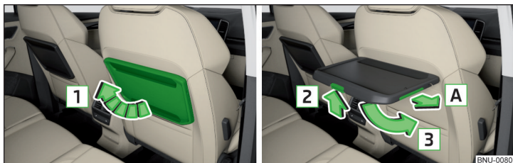
Obr. 114 Vyklopení stolu / Sklopení stolu a vysunutí držáku nápojů
