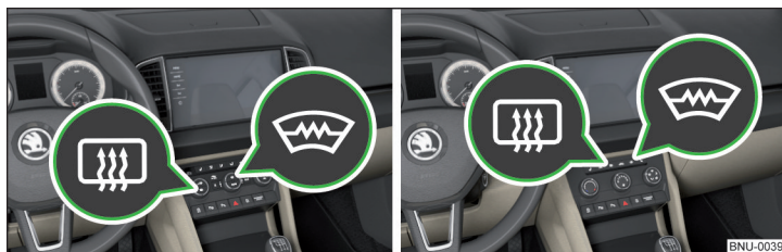
Obr. 68 Tlačítka vyhřívání čelního a zadního skla: Climatronic / Manuální klimatizace
