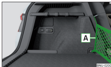
Obr. 130 Příklady upevnění sítí: varianta 3
