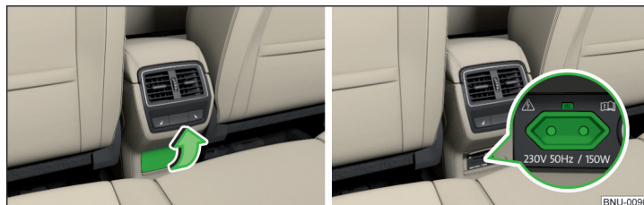
Obr. 120 Odklopení krytu 230V zásuvky / 230V zásuvka
