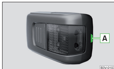
Obr. 323 Zápádka krytu akumulátorů
