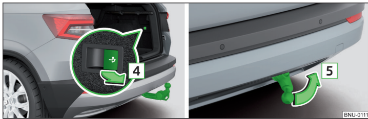
Obr. 289 Tažné rameno: zaklopení
