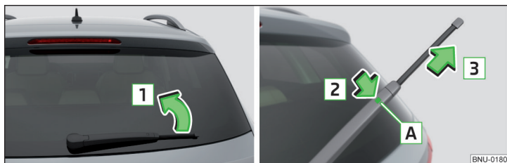
Obr. 330 Výměna stírací lišty zadního skla
