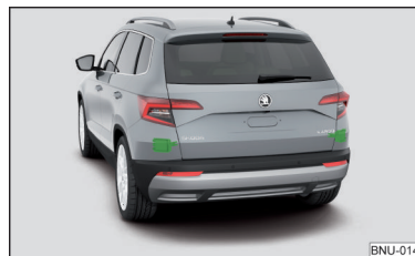
Obr. 257 Umístění radarových snímačů
