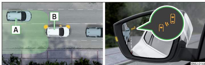
Obr. 259 Jízdní situace / Kontrolní světlo v levém vnějším zrcátku upozorňuje na jízdní situaci
