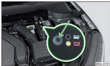
Obr. 302 Akumulátor: ukazatel hladiny elektrolytu
