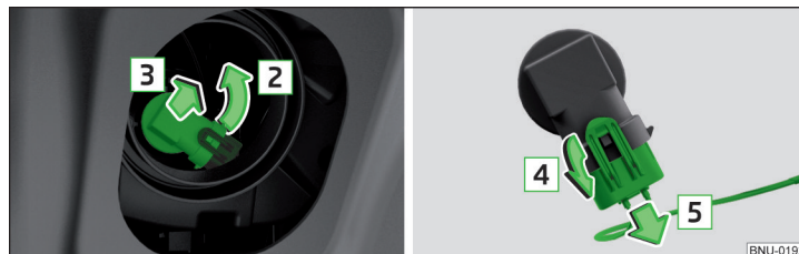
Obr. 342 Výměna žárovky mlhového světla
