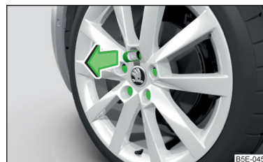
Obr. 311 Stažení krytky šroubu kola
