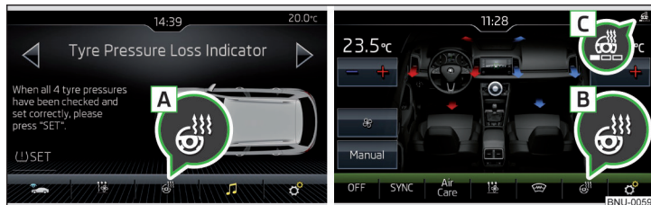
Obr. 93 Vyhřívání volantu: Manuální klimatizace / Climatronicon
