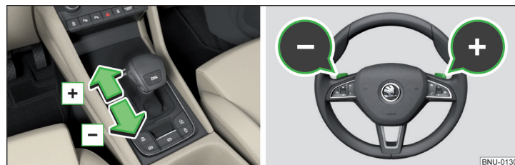
Obr. 245 Volící páka / Multifunkční volant
