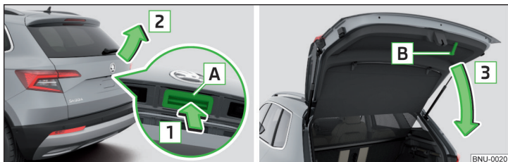
Obr. 49 Otevření/zavření víka zavazadlového prostoru
