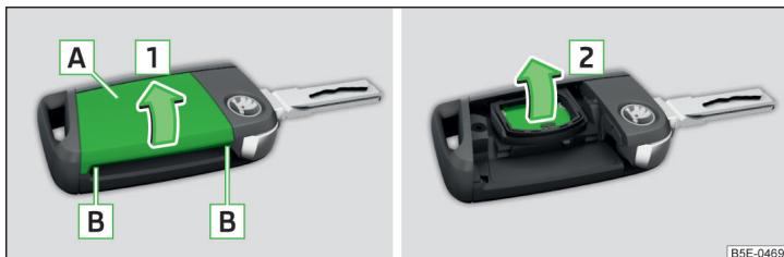
Obr. 321 Odklopení krytu / Vyjmutí baterie
