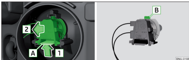
Obr. 338 Výměna žárovky potkáváčiho a dálkového světla
