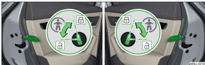
Obr. 47 Zadní dveře: zapnutí / vypnutí dětské pojistky
