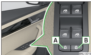
Obr. 48 Elektricky ovládaná dětská pojistka
