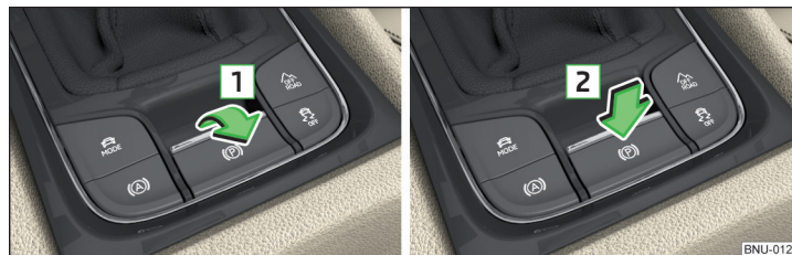
Obr. 240 Ovládání parkovací brzdy
