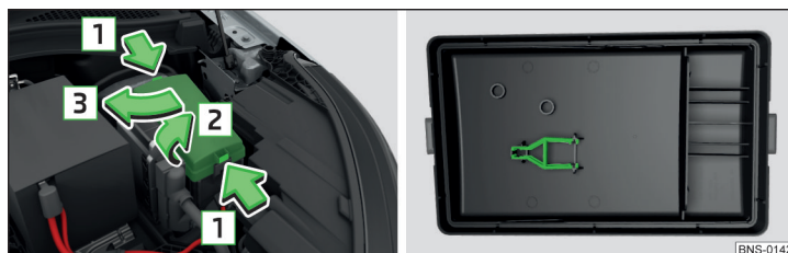
Obr. 371 Kryt pojistek: vyjmutí krytu / plastová svorka na pojistky
