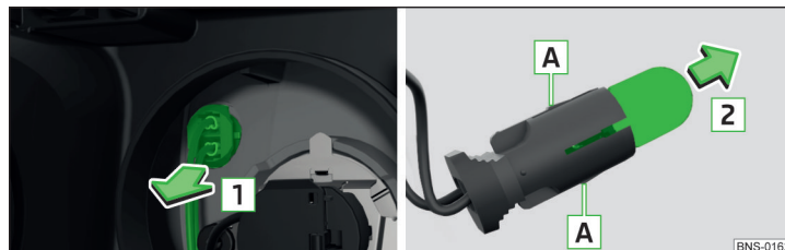
Obr. 377 Výměna žárovky obrysového světla
