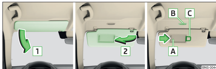
Obr. 63 Sklopení clony / Vyklopení clony / Kosmetické zrcátko s osvětlením a držákem na lístky
