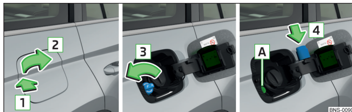
Obr. 328 Odklopení krytu hrdla palivové nádrže / Vyšroubování uzávěru / Nasazení uzávěru na kryt
