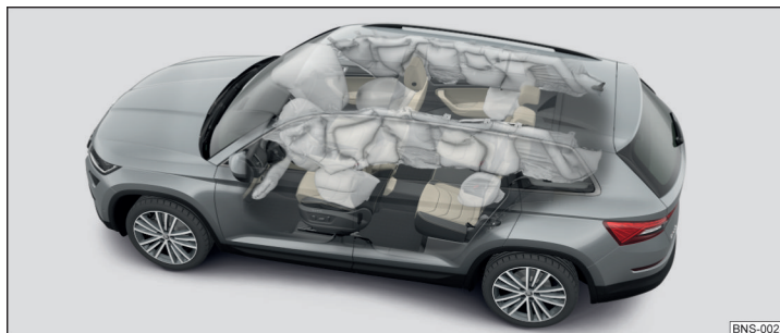
Obr. 10 Plynem naplněné airbagy
