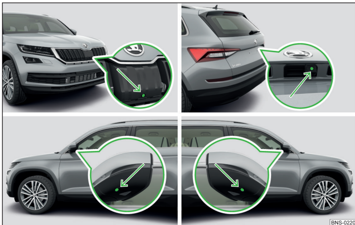
Obr. 284 Umístění kamer pro snímání okolí
