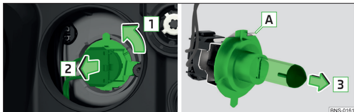
Obr. 376 Výměna žárovky dálkového světla
