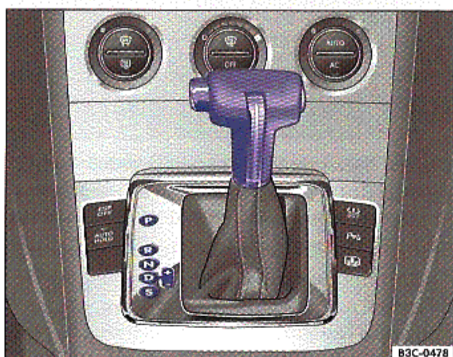
Obr. 8 Středová konzola: volicí páka automatické převodovky nebo převodovky s dvojitou spojkou (DSG)
