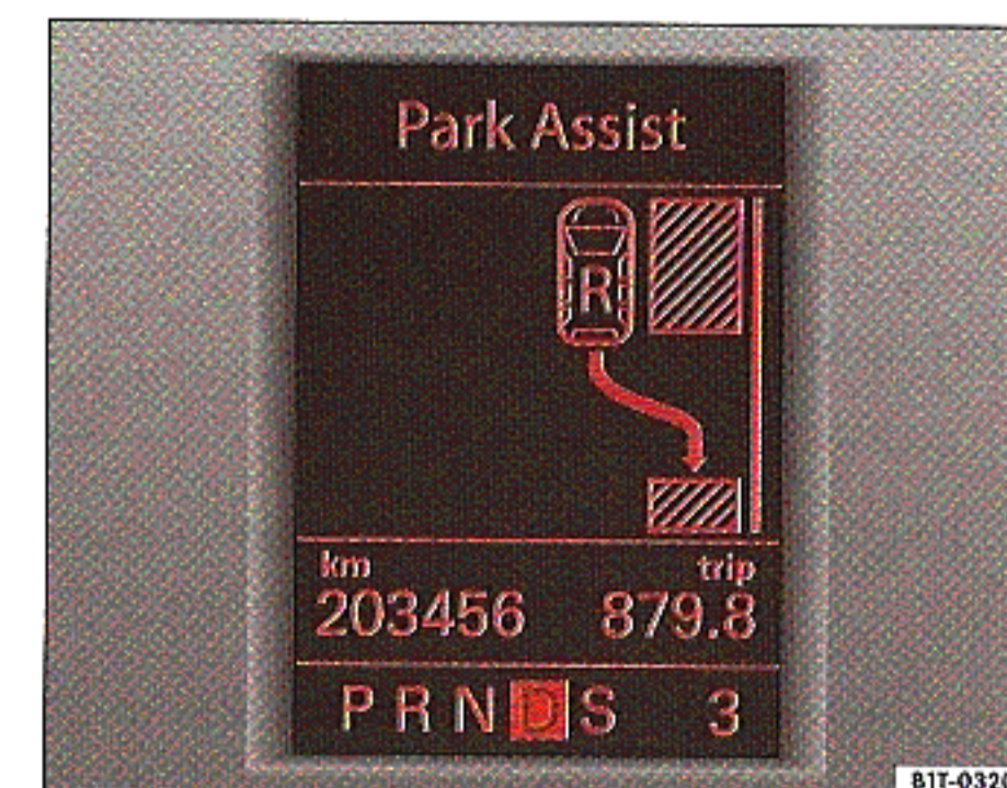
Obr. 29 Displej sdružených přístrojů: Parklücke erkannt mit dem Hinweis, den Rückwärtsgang einzulegen (místo k zaparkování rozpoznáno, zařadte zpátečku podle pokynů)
