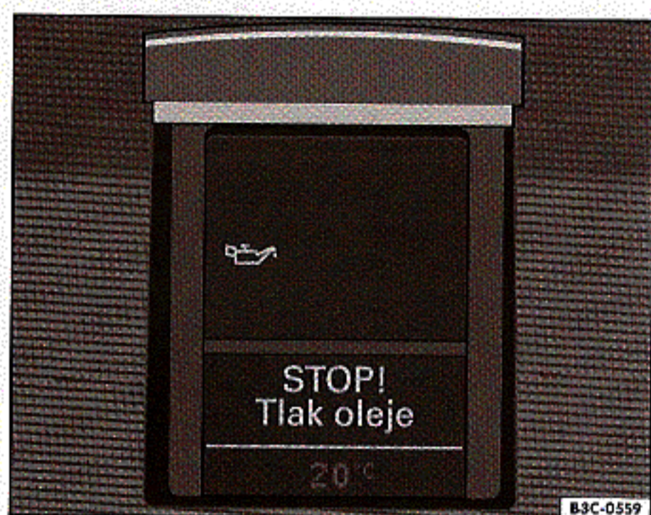
Obr. 9 Kontrolní světlo a varovný text vozidel s malým zobrazovacím polem na displeji sdružených přístrojů: STOP! Öldruck (stop! tlak oleje)
