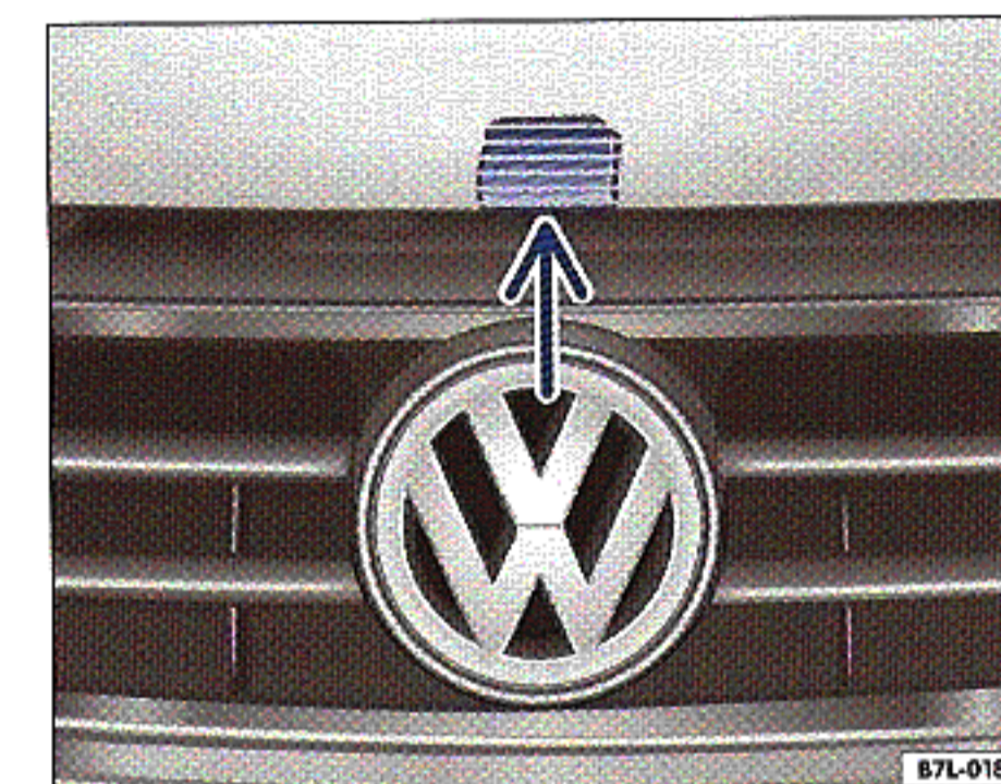
Obr. 6 Mřížka chladiče: otevření kapoty motorového prostoru
