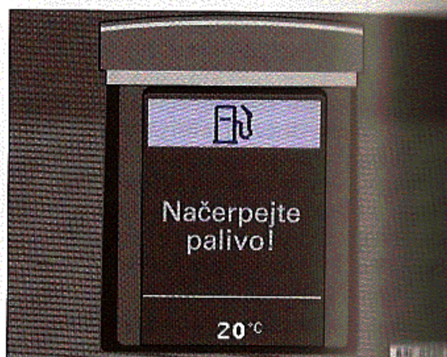
Obr. 10 Symbol a varovný text vozidel s velkým zobrazovacím polem na displeji sdružených přístrojů: Bitte tanken! (načerpajte palivo!)
