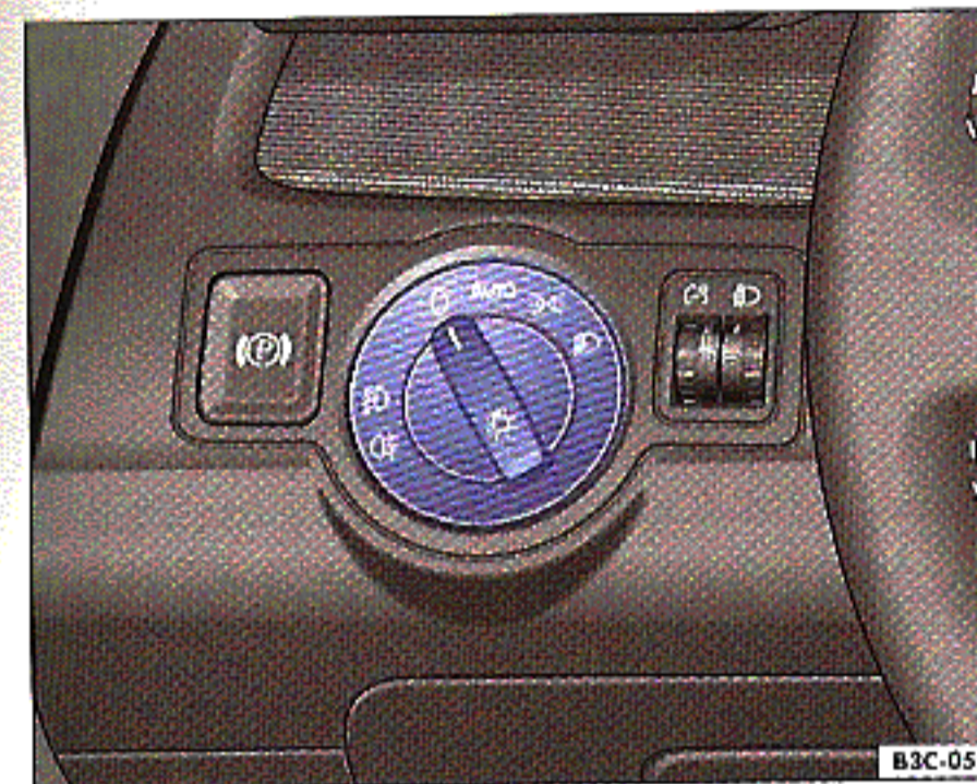
Obr. 42 Přístrojová deska: spínač světel, automatické ovládání tlumených světel, mlhových světlometů a mlhového koncového světla
