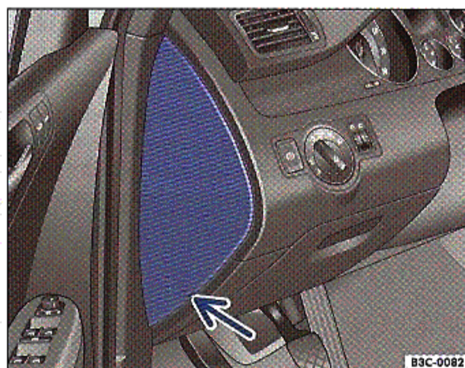
Obr. 43 Přístrojová deska vlevo: kryt pojistkové skříňky
