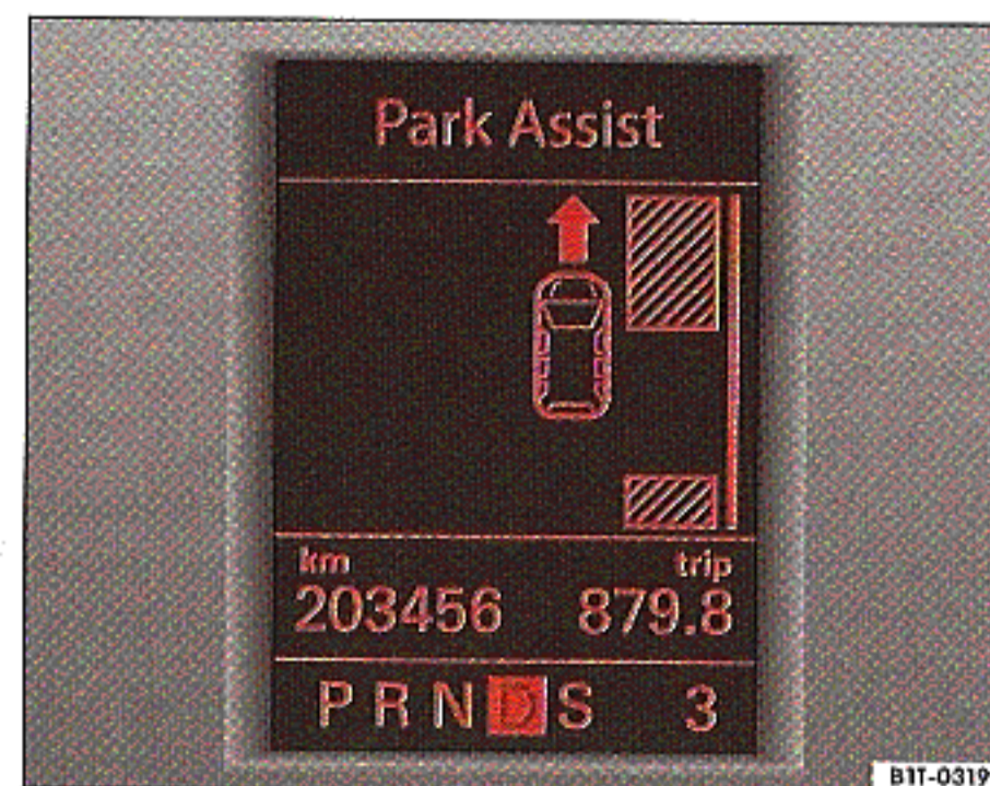
Obr. 28 Displej sdružených přístrojů: Parklücke erkannt mit dem Hinweis weiter vorzufahren (místo k zaparkování rozpoznáno, pokračujte v jízdě dopředu podle pokynů)
