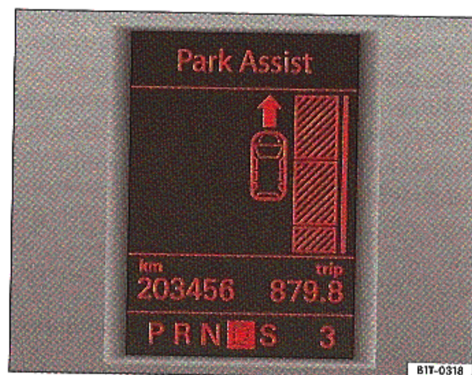
Obr. 27 Displej sdružených přístrojů: nalezení vhodné mezery pro parkování
