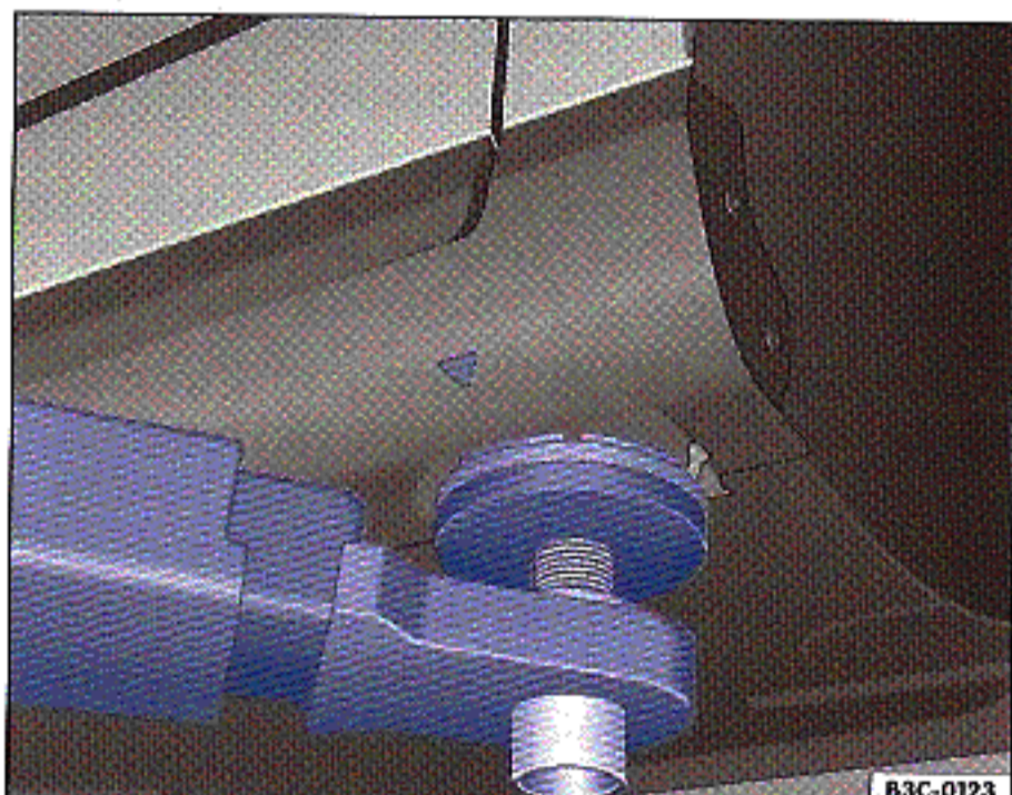
Obr. 52 Zvedání vozidla na sloupovém zvedáku: upínací body vpředu
