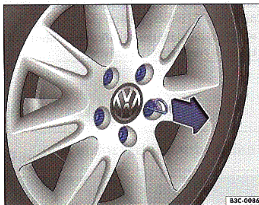
Obr. 30 Stáhnutí krytek ze šroubů kola
