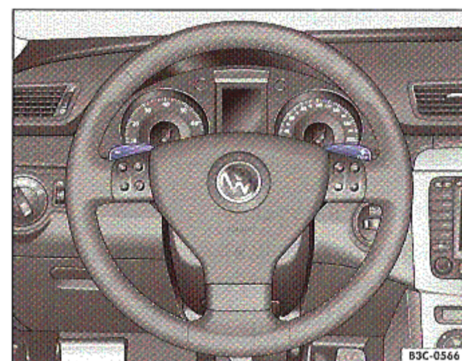
Obr. 10 Multifunkční volant s kolébkovými spínači automatické převodovky nebo převodovky s dvojitou spojkou (DSG)
