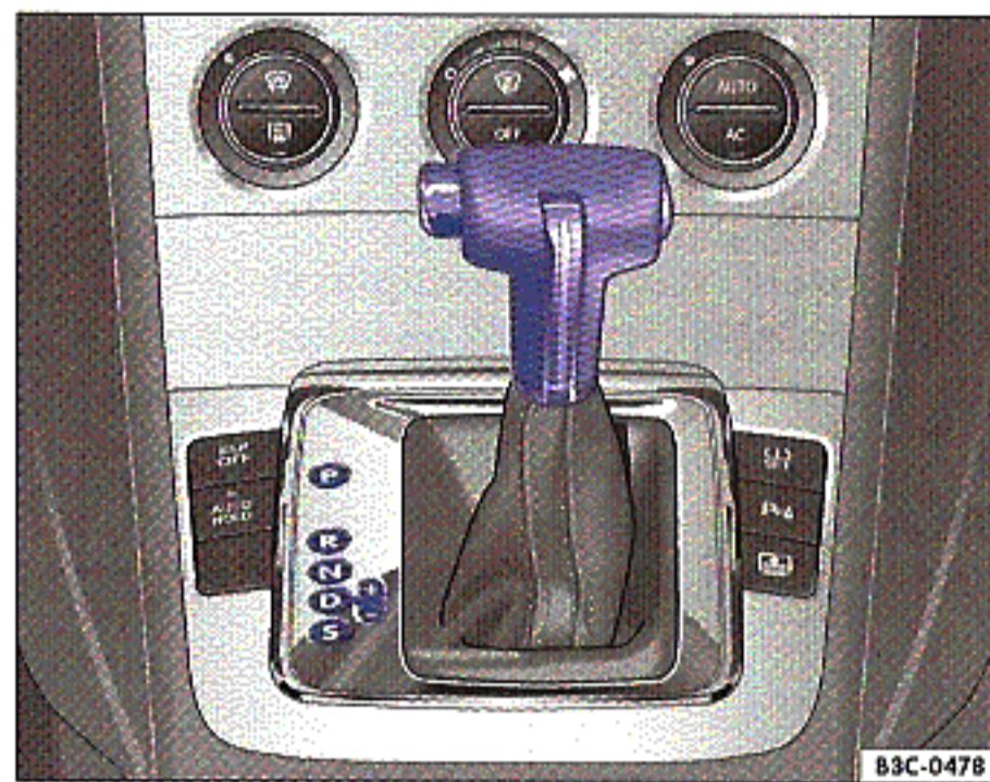
Obr. 7 Středová konzola: volicí páka automatické převodovky nebo převodovky s dvojitou spojkou (DSG)
