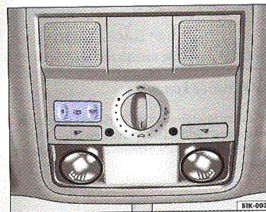
Obr. 46 Podhled střechy: spínač vnitřního osvětlení vpředu
