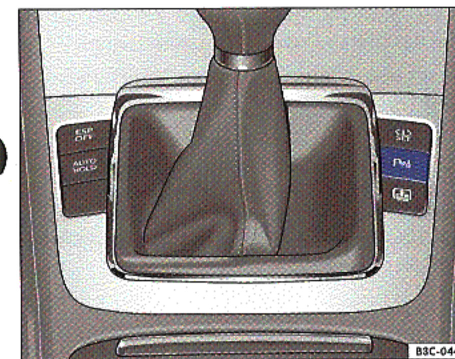
Obr. 16 Přístrojová deska: tlačítka pro zapnutí nebo vypnutí kontroly vzdálenosti při parkování
