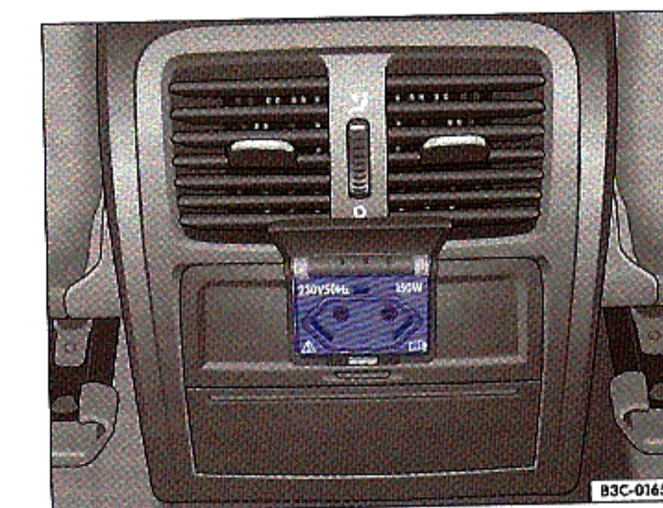
Obr. 100 Středová konzola vzadu: eurozásuvka 230 V
