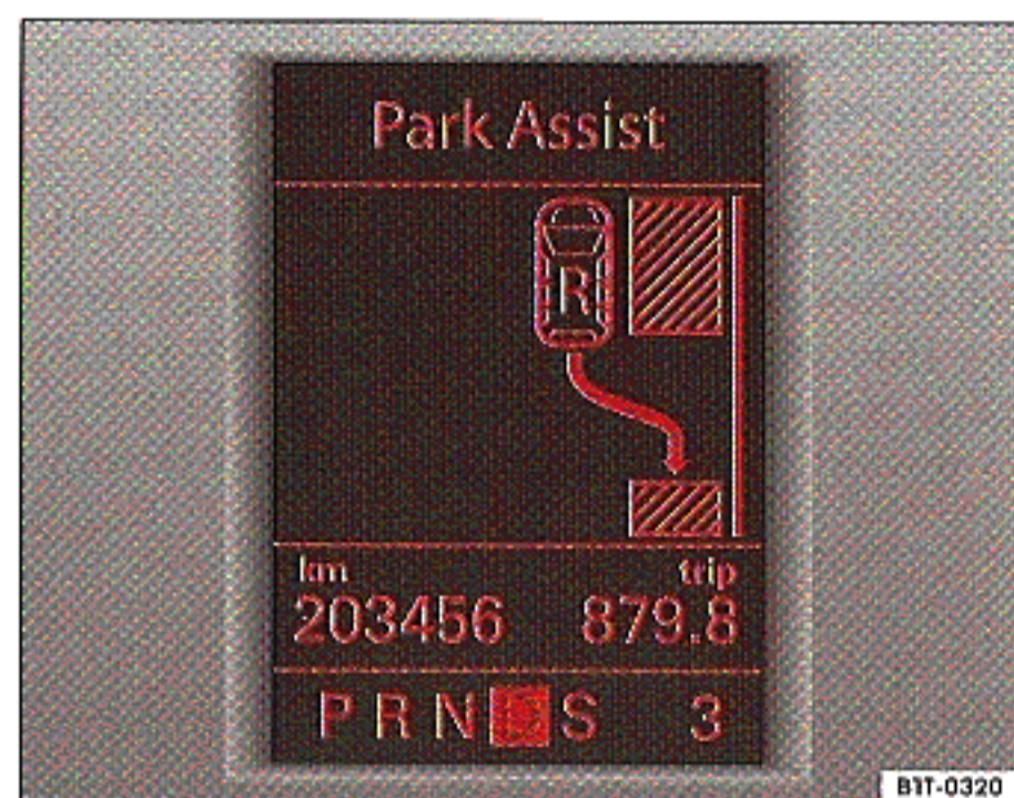
Obr. 30 Displej sdružených přístrojů: rozpoznání volného místa, zařazení zpětného chodu
