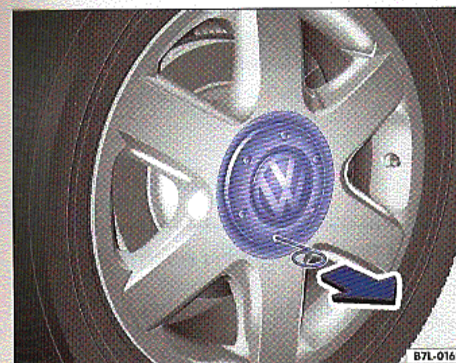
Obr. 28 Stáhnutí krytu středu kola
