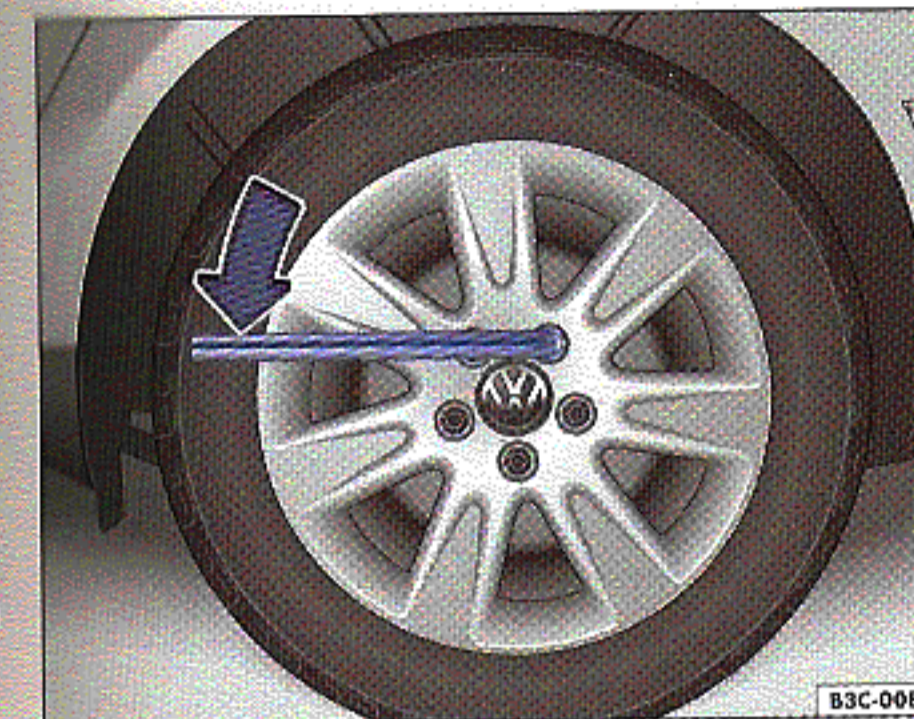
Obr. 32 Výměna kola: povolení šroubů
