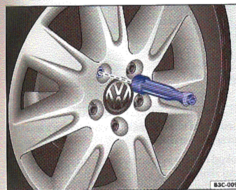
Obr. 36 Výměna kola: našroubování šroubů kol rukojetí šroubováku
