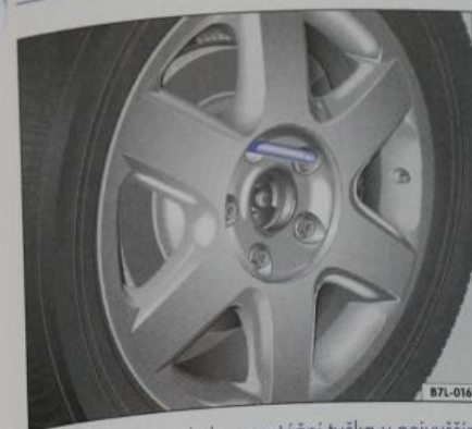
Obr. 37 Výměna kola: montážní tyčka v nejvyšším otvoru
