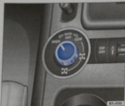
Obr. 13 Středová konzola: otočný knoflík s uzávěrkou mezinápravového diferenciálu a diferenciálu zadní nápravy
