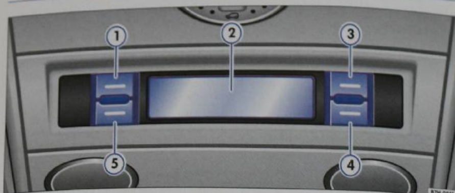
Obr. 95 Pohled střechy: ovládací prvky nezávislého topení
