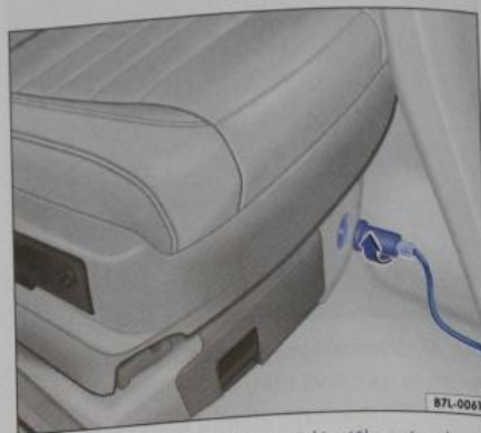
Obr. 39 Vozidla s regulací světlé výšky: vývod pro plnicí hadičku u pravého předního sedadla
