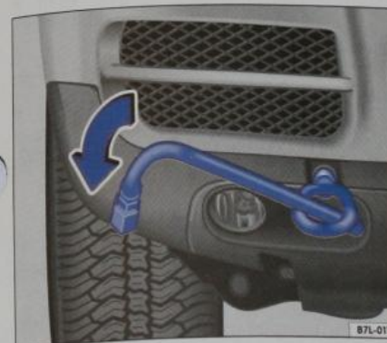
Obr. 53 Přední část vpravo: našroubování vlečného oka
