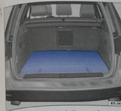
Obr. 80 Oboustranná rohožka na podlaze zavazadlového prostoru v původním stavu
