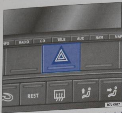
Obr. 44 Přístrojová deska: spínač varovných světel
