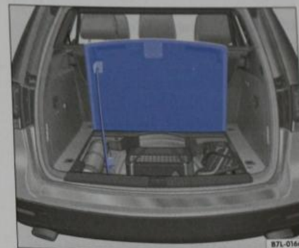
Obr. 23 Pod zvednutým krytem podlahy: palubní nářadí, skládací klíny, souprava na opravu pneumatik a druhý akumulátor.
