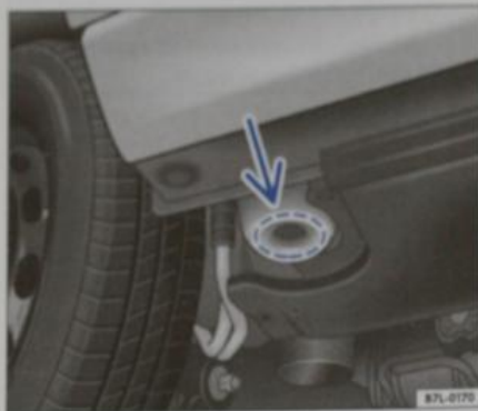
Obr. 55 Zvedání vozidla na sloupovém zvedáku: upínací bod vpředu
