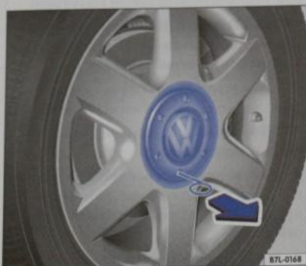
Obr. 31 Výměna kola: seřnutí krytu středu kola
