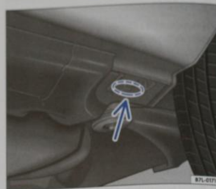
Obr. 56 Zvedání vozidla na sloupovém zvedáku: upínací bod vzadu
