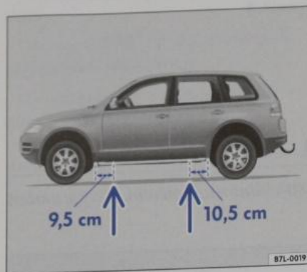
Obr. 35 Upínací body pro nasazení zvedáku
