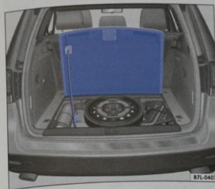
Obr. 22 Pod zvednutým krytem podlahy: palubní nářadí, skládací klíny a rezervní skládané kolo
