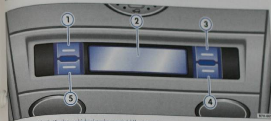
Obr. 93 Pohled střechy; ovládací prvky nezávislého topení
