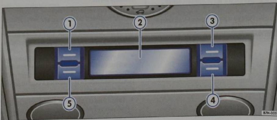
Obr. 91 Podhled střechy: ovládací prvky nezávislého topení
